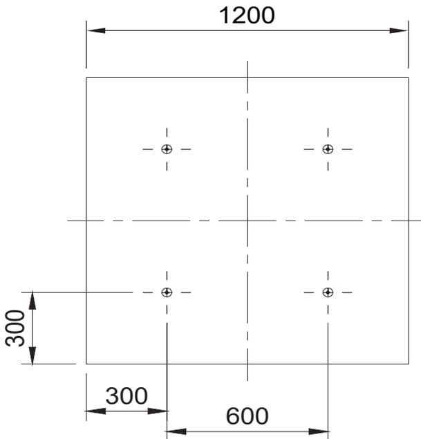
**Tipp:** Verwenden Sie einen Kreuzlinienlaser zum Markieren und Ausrichten der Deckensegel.
